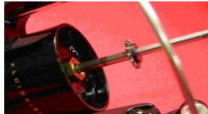
6. Ta quase no fim. Girando a manivela observe o eixo onde se coloca o carretel subir e descer. Quando estiver com a maior parte de seu corpo para fora, pare e pingue uma gota de óleo nele, gire novamente a manivela por várias vezes até que fique lubrificado;
